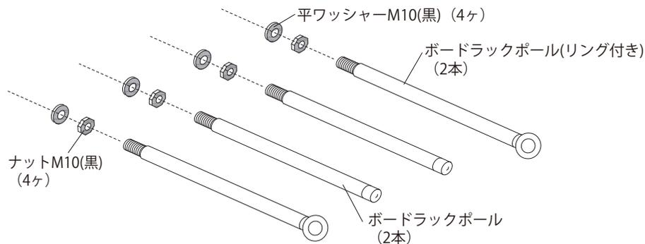
② ボードラック下地材にボードラックポールとボードラック補強をナットと平ワッシャーで固定します。
