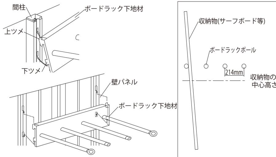
② ボードラッククッションゴムはボードラック下地材と収納物（サーフボード等）が直接当たらないように、位置を決めて両面テープで貼付けます。
