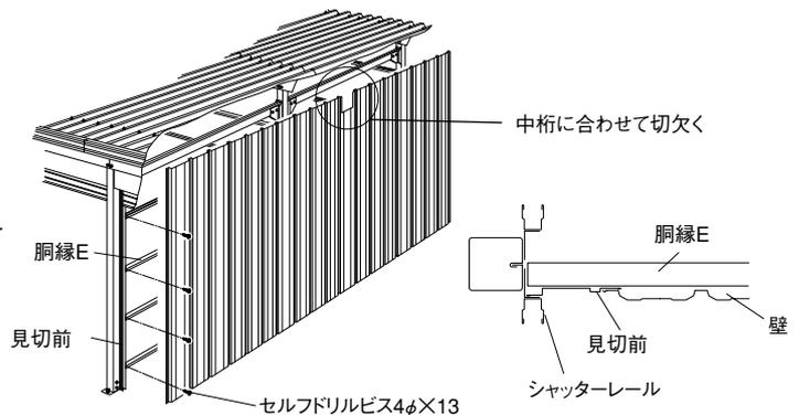
**注意** 正面より向かって右側に目隠しがつく場合は、図のように、壁を胴縁Eに取付けた後に見切前を取り付けてください。
