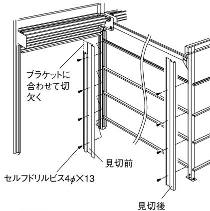
**注意** 正面より向かって右側に目隠しがつく場合は、壁パネルを取り付けた後に見切前を取り付けてください。
