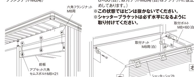
②シャッターブラケット左右を前柱に取り付けます。(六角フランジボルトM8×100、六角フランジナットM8)
