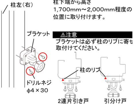
柱左(右) 柱下端から高さ1,700mm~2,000mm程度の位置に取り付けます。
