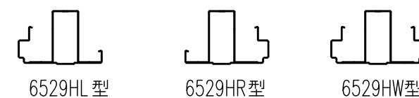
中柱 断面図 (S=1/10)
