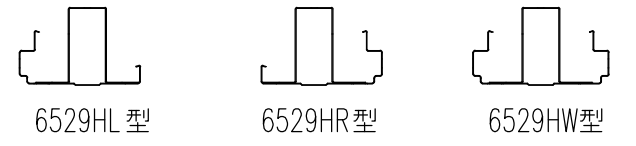
中柱断面図 (S=1/10)
