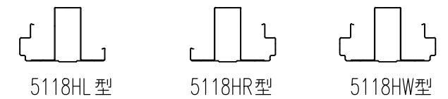
中柱断面図 (S=1/10)
