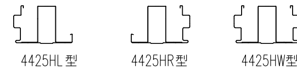
中柱断面図 (S=1/10)
