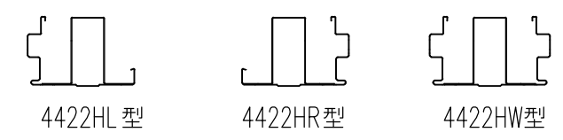
中柱断面図 (S=1/10)
