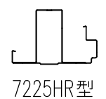
中柱 断面図 (S=1/10)
