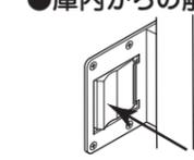
鍵を使って施錠し、内部の解除レバーで解錠した場合、鍵のOPEN、LOCKの表示がLOCKのままになりますので、必ず鍵を使って表示を合わせ直してください。(鍵を一度時計回りに180°回転させると表示がOPENに戻ります。)
